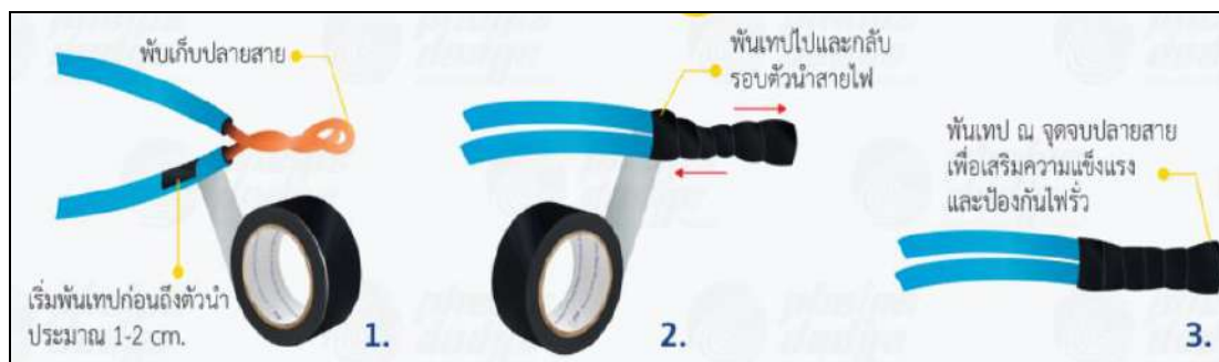
ภาพที่ 24 แสดงตัวอย่างการพันเทปพันสายไฟแบบที่ 1
