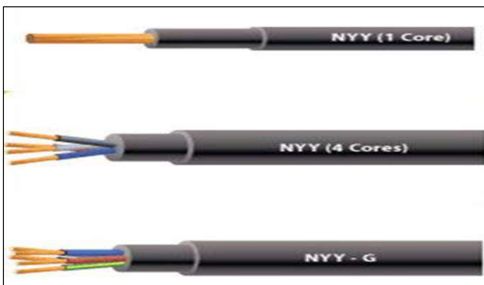
ภาพที่ 10 แสดงสายไฟฟาชชนิด NYY สามารถฝังใต้ดิน มีตั้งแต่แกนเดี่ยวถึง 4 แกนหุ้มฉนวน PVC 2 ชั้นแรงดัน 750V 70°C
