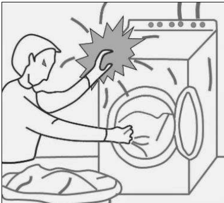
ภาพที่ 47 แสดงตัวอย่างอันตรายจากการสัมผัสโดยอ้อมเนื่องจากไฟฟ้ารั่วที่เครื่องซักผ้า
