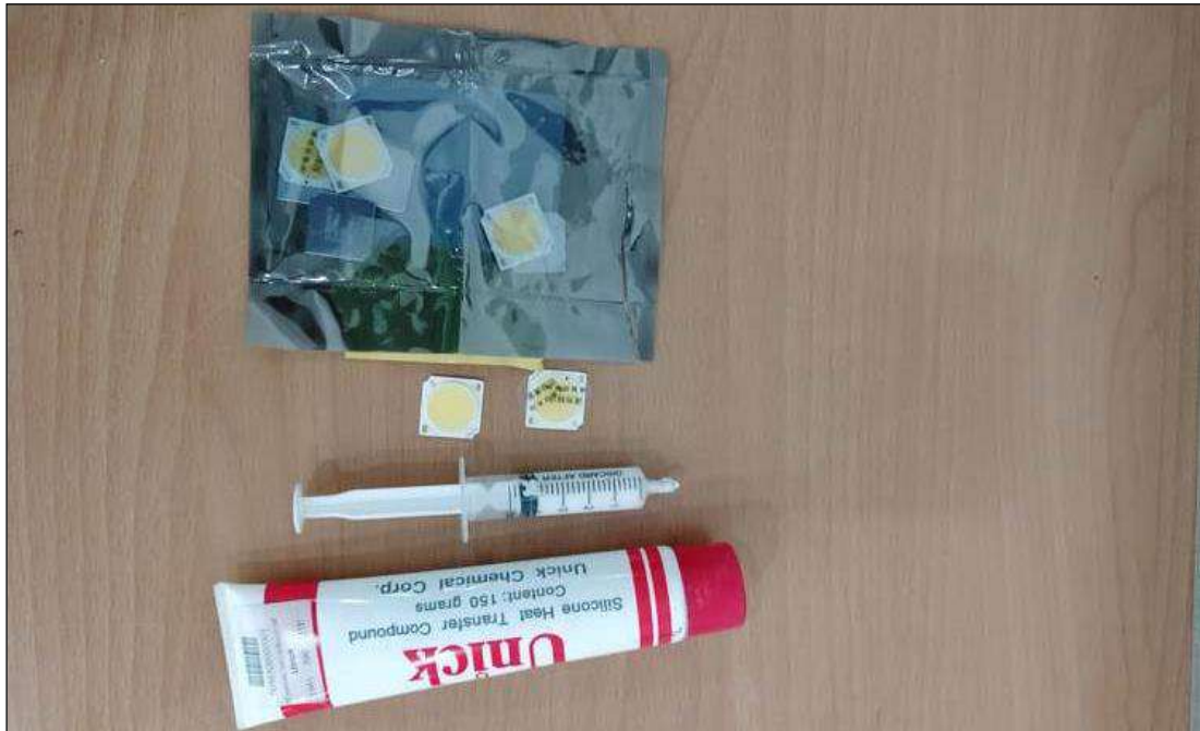
ภาพที่ 76 แสดง Chip หลอดLED และSiliconeระบายความร้อน
