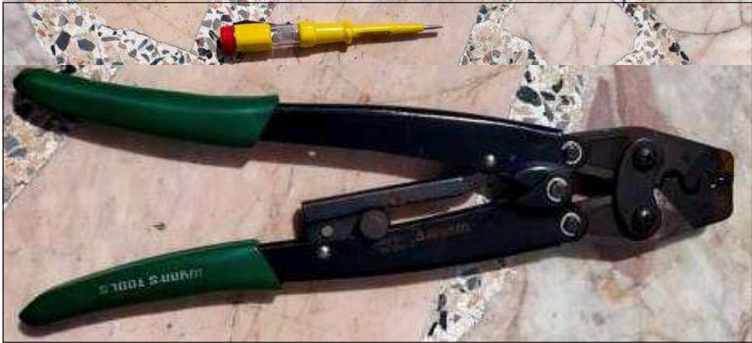
ภาพที่ 68 แสดงไขควงเช็คไฟและคีมย้ำสายไฟ
